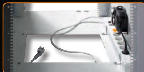
Dessous ouvert pour permettre le passage de la connectique sur un plancher informatique. Une rampe 5 prises de courant 230 Vac avec disjoncteur différentiel 30 mA/16A et interrupteur lumineux, homologuée NF C 15-100 est fixée au bas de l'armoire.
