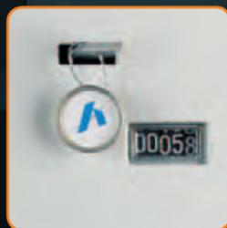
Le foncet, ou contre-porte, en tôle d'acier 20/10<sup>ème</sup> de mm, est plombé en deux points pour visualiser toute fraude sur le mécanisme. Un compteur d'ouverture à lecture horizontale à 5 chiffres, infalsifiable, actionné à la fermeture, est protégé par le foncet.
